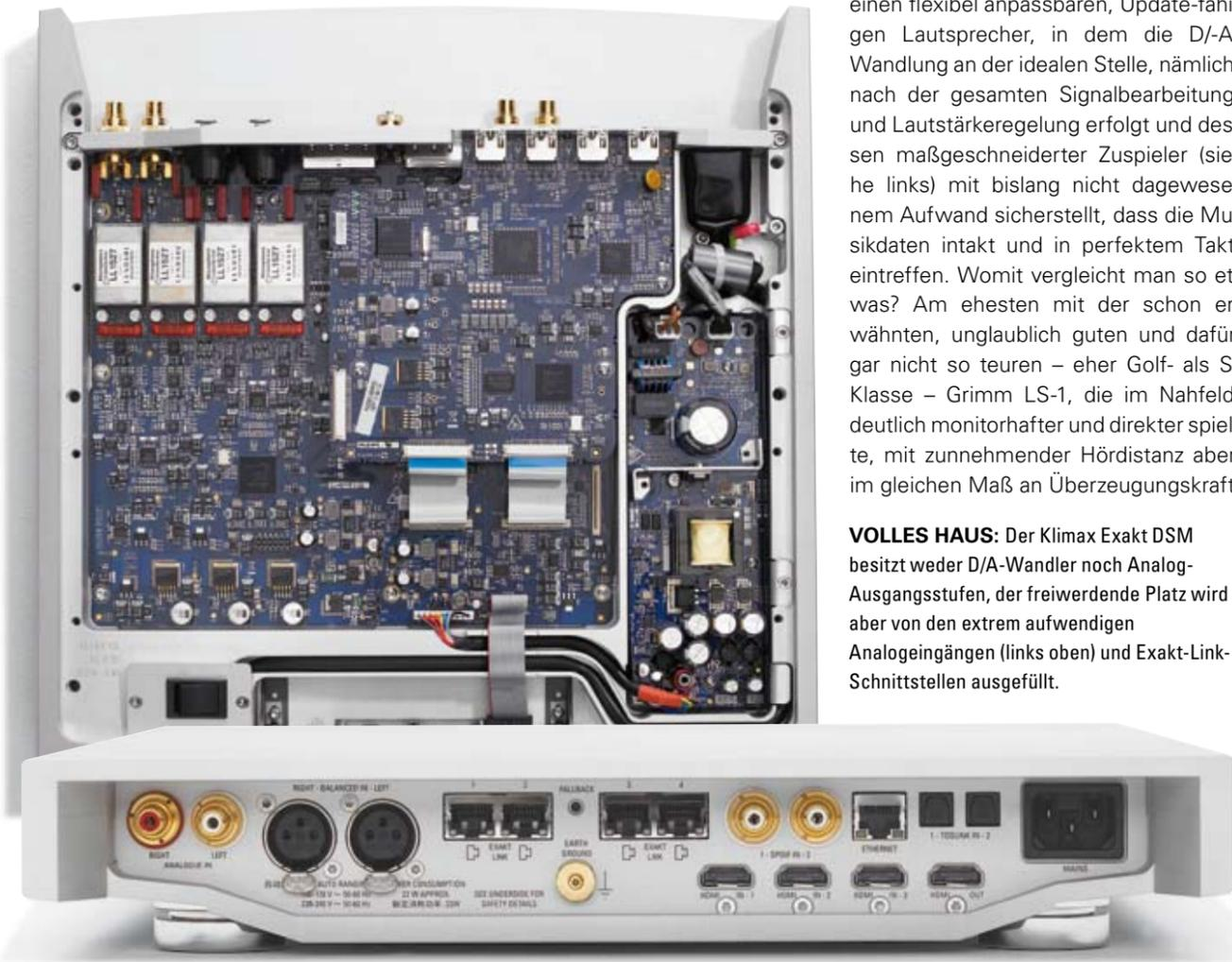
**NEUE GATTUNG:** Das Anschlussfeld des DSM hält zwei Analog-Inputs bereit, dann folgen vier Exakt-Link-Ausgänge, Koax- und optische S/PDIF-Inputs sowie eine Reihe HDMI-Anschlüsse samt Ausgang. Letzterer gibt eventuelle Bildanteile des HDMI-Signals unverändert weiter.
