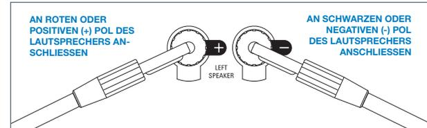
Die Schraub-/Steckanschlüsse können als Buchsen für den Anschluss von 4-mm-Bananensteckern oder für den Anschluss von blanken Leitern oder Kabelschuhen verwendet werden. Hierzu müssen Sie den Außenteil des Schraub-/Steckanschlusses lösen. Führen Sie das Kabel oder den Kabelschuh ein, und ziehen Sie den Schraub-/Steckanschluss wieder an, um die Klemmverbindung herzustellen.
