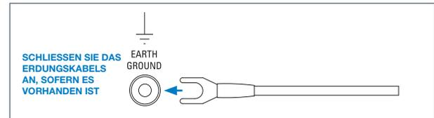
Wenn durch den Anschluss jedoch Nebengeräusche (Brummen usw.) entstehen oder die Klangqualität herabgesetzt wird, trennen Sie den Erdanschluss wieder ab: Bestimmte Tonarme/Tonabnehmersysteme funktionieren ohne Erdungsanschluss besser.
